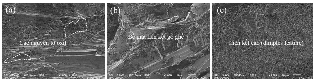
Hình 4.45. Hình SEM bề mặt phá hủy được chế tạo bởi chiều dài chốt hàn (mm) và chiều sâu ép chốt (mm) khác nhau (a) 2,9 - 0,20, (b) 2,8 - 0,30, (c) 3,0 - 0,20
