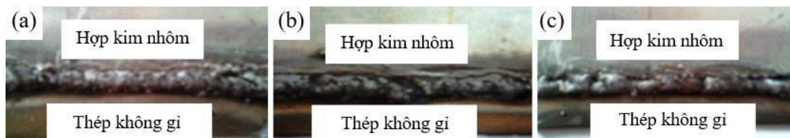
Hình 1.12. Mặt liên kết mối hàn chồng AA6061/SUS304 bằng hàn MIG dưới tác dụng các hiệu điện thế khác nhau (a) 17 V, (b) 18 V, (c) 19 V [23]
