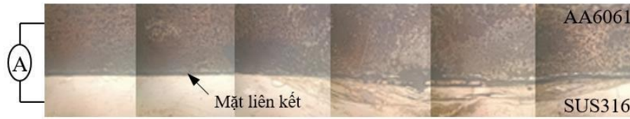
Hình 2.20. Sơ đồ ăn mòn điện hóa mối hàn AA6061/SUS316
