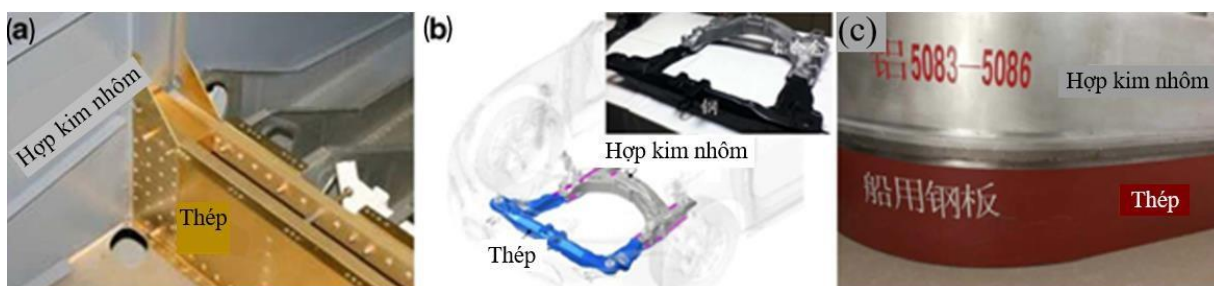
Hình 1.10. Ứng dụng của cấu trúc hỗn hợp nhôm/thép trong các ngành công nghiệp (a) hàng không vũ trụ, (b) ô tô, (c) đóng tàu [57]
