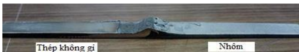
Hình 1.9. Mặt ngoài mối hàn giữa AA6061 với AISI304 bằng phương pháp hàn ma sát áp lực “friction crush welding” [61]
