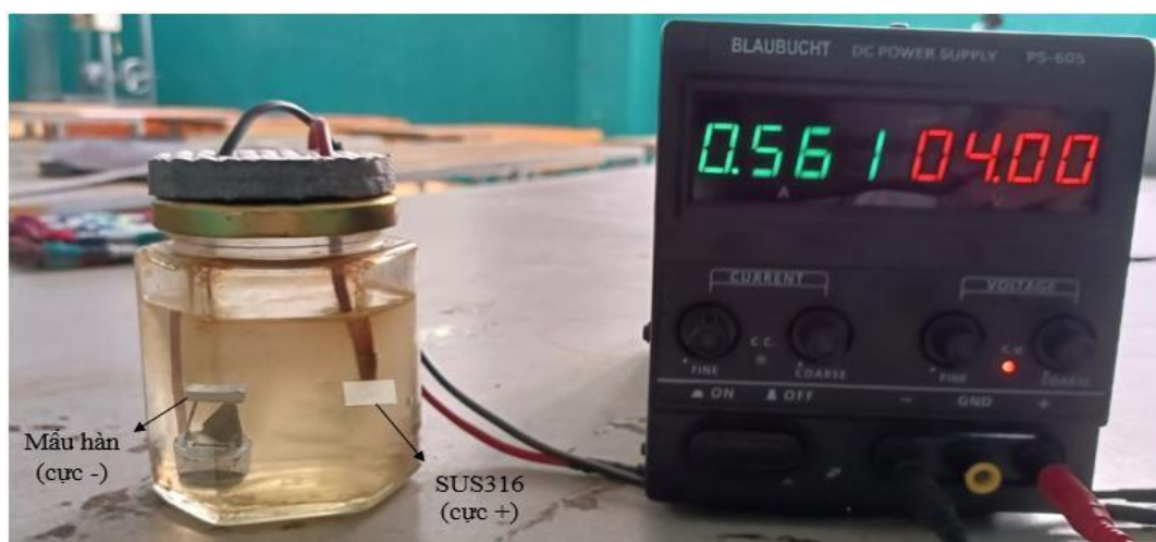
Hình 3.17. Mẫu ngâm dung dịch 3,0 %NaCl và tác dụng hiệu điện thế khác nhau
