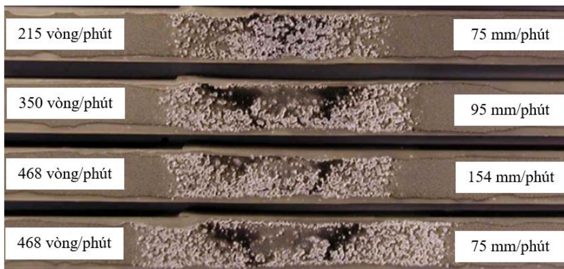
Hình 2.23. Ăn mòn trên mặt cắt ngang mối hàn chồng FSW AA2024-T351 với tốc độ quay và vận tốc hàn khác nhau [129]
